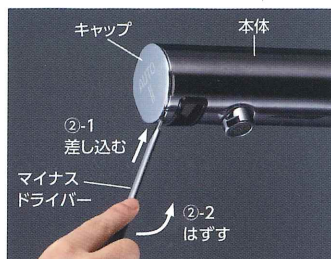
②本体下面の溝にマイナスドライバーを差し込みひねって、キャップをはずします。
