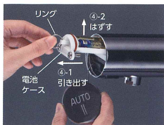
④リングを引っ張り、電池ケースを引き出し、使用済みの乾電池を取り出します。
