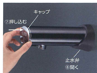
⑦「AUTO」の文字が上下正しくなる向きに合わせて、キャップを本体に「カチッ」と音がするまで押し込んでください。 ⑧①でしめた止水弁を開き、流量を調節します。
