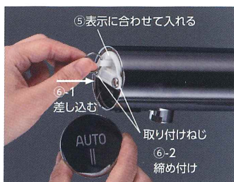
⑤電池ケースに新品の単3アルカリ乾電池2本を入れます。 ⑥電池ケースを本体に差し込み、取り付けねじ(2か所)をしめます。
