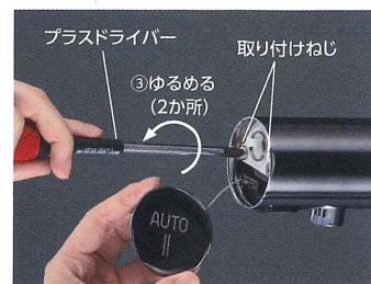
③プラスドライバーで電池ケースの取り付けねじ(2か所)を緩めます。
